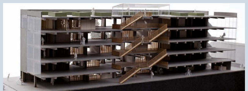
Das neue Treppenhaus bringt Licht in die Tiefe für die neue Nutzung.
